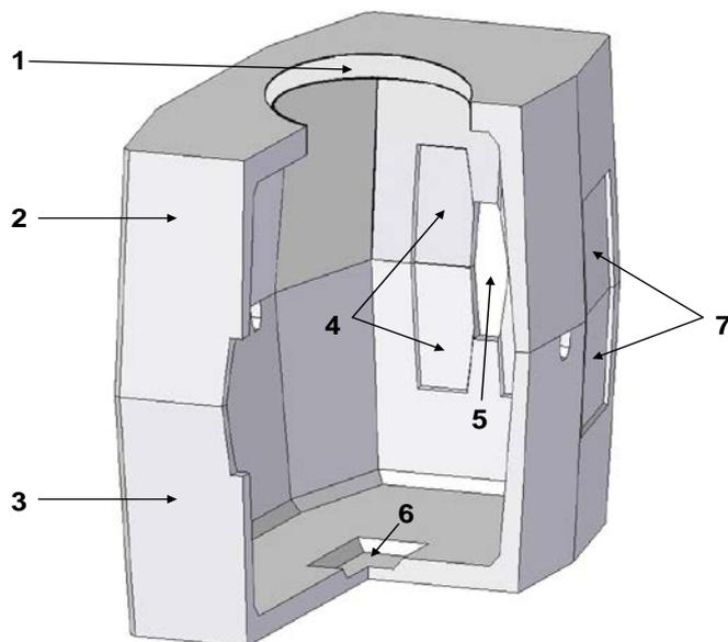
Рис. 4. Колодец «ККСр-3-10» в сборе, внешний вид и детали элементов колодца:
