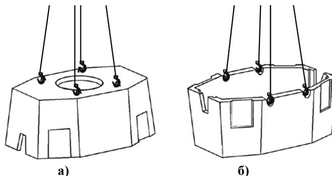
Рис. 9. Строповка элементов «ККСр-3-10»: а – верхнего элемента; б – нижнего элемента.
