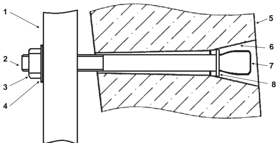
Рис. 3.3. Крепление кронштейна типа ККП с помощью ершей с резьбой:
